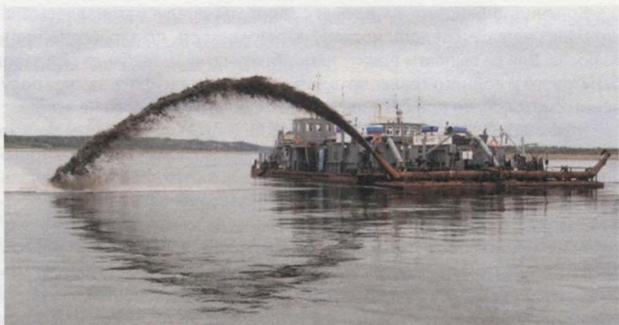
Гидроприставка катамарана. Вариант 3 с трубами D = 500 мм
